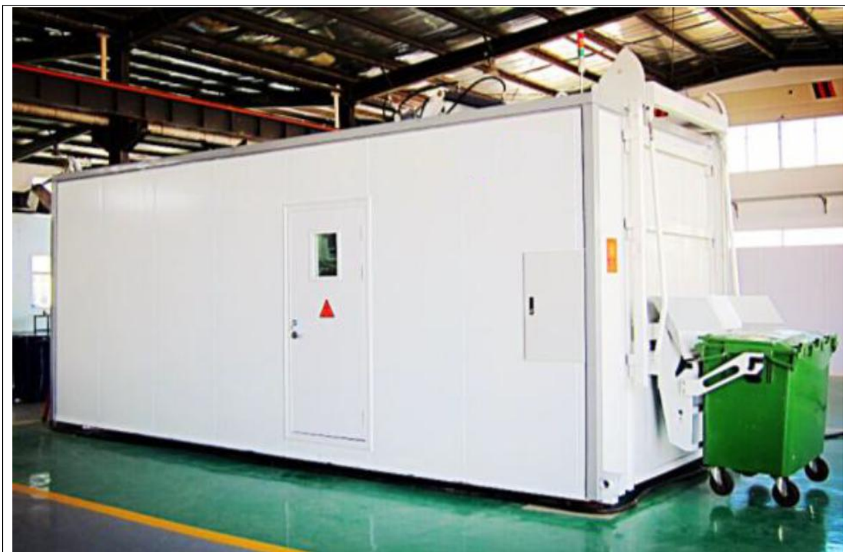
图 3-4 微波消毒处理系统示范装置图
